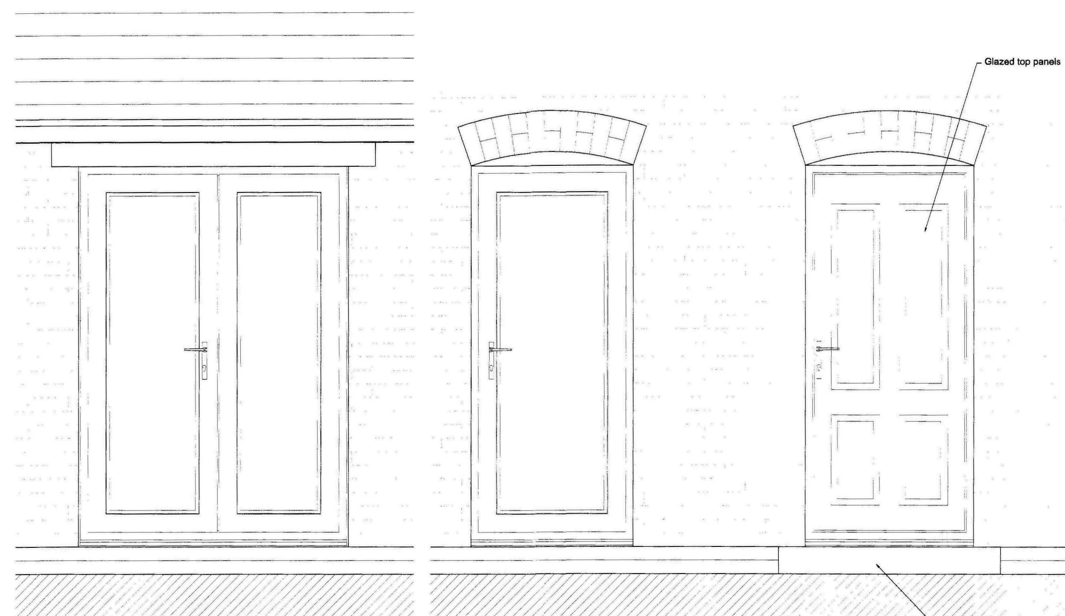
Door, Door Head & Step Elevations 1:20
