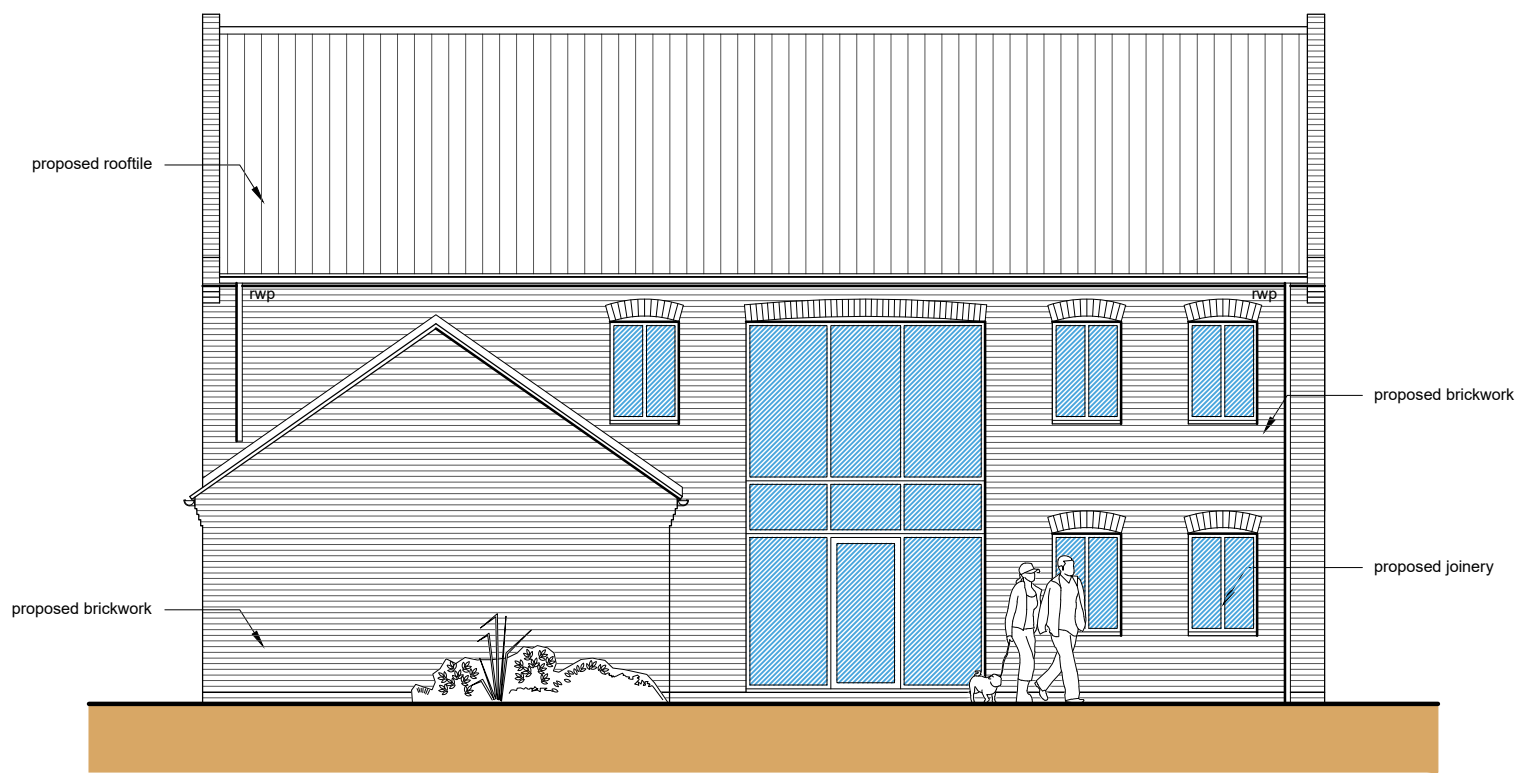
Front Elevation (NW) Scale: 1:100
